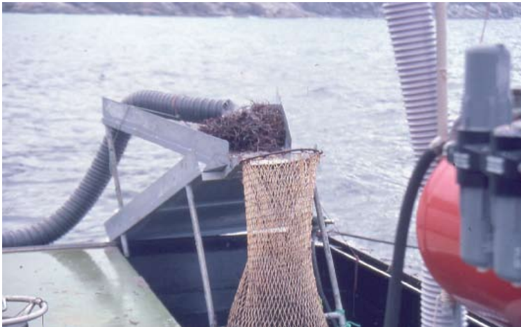
Boca de descarga del equipo para corte de algas
